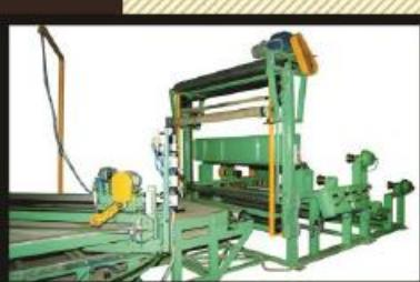
دستگاهی ته برای برداش لایه های مفید (لایه های تولید شده در دستگاه کلندر) با زاویه ای ثابت که برای هر سایز متفاوت است مورد استفاده قرار می کردد. از لایه های تولید شده در این دستگاه برای ساخت مفید (کراس) استفاده می شود.
